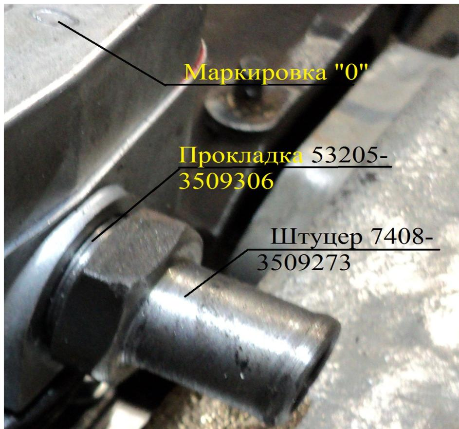
Фото 8. Установка штуцера 7408-3509273 в отверстие М26х1,5 для всасывания воздуха.
