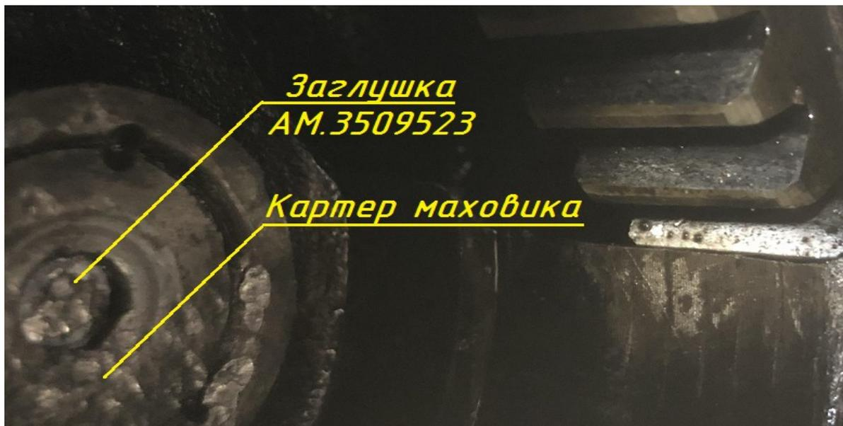
Фото 2. Закрушка АМ.3509523 установлена в масляный канал картера маховика диаметром Ø8 мм.
