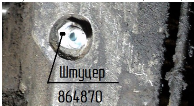
Фото 4. Штуцер 864870 установлен в картер маховика.
