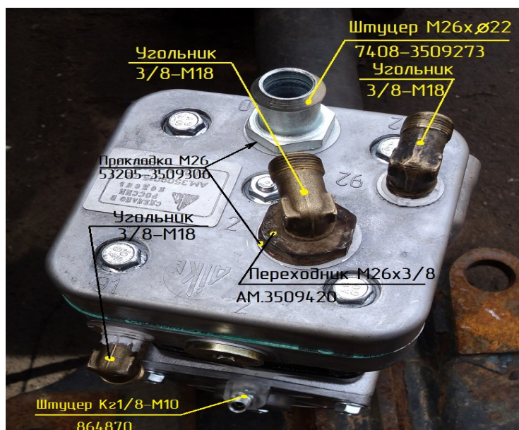
Фото 6. Установка угольников 3/8-M18, переходника AM.3509420-01 с угольником 3/8-M18 для нагнетания воздуха и штуцера 7408-3509273 на компрессор AM.3509015-05.
