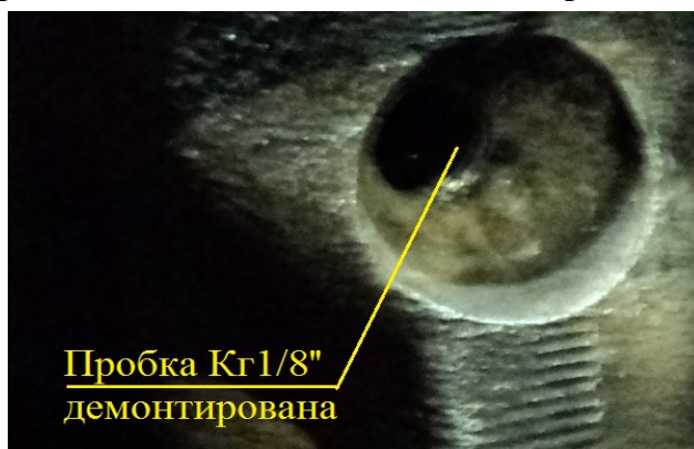
Фото 3б - пробка в Картере маховика вывернута;
