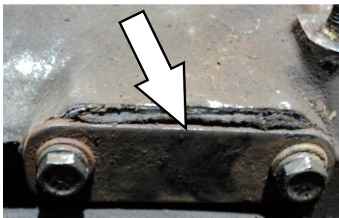
Фото 1. Заглушка 740.1115040 с прокладкой 740.3509413 закрывает окно воздушного коллектора.
